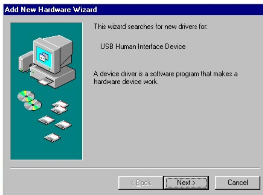
Sluit de K8047/PCS10 aan via de meegeleverd USB-kabel aan de USB interface connector op je PC. De volgende boodschap moet dan verschijnen en klik "NEXT(Volgende)" om de H.I.D. USB driver te installeren indien nodig. Controleer of de groene led (POWER).
